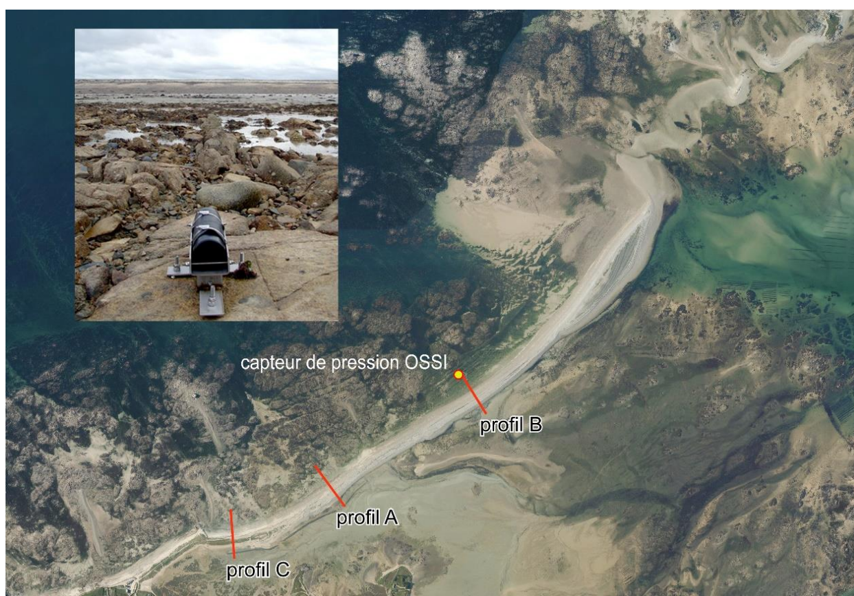
Figure 4A – Localisation des trois profils de mesures topo-morphologiques et du capteur OSSI de pression de houle et de niveaux d'eau. Ce dernier est installé dans la zone intertidale à -0,461 m NGF. Le fond de carte correspond à l'ortho-photographie IGN de 2012, la brèche ouverte au mois de mars 2018 n'est pas présente).
