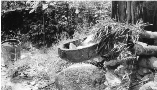
La machine à piler le riz dans son environnement naturel : l'eau arrive de la droite par un tuyau en bambou et remplit le godet (Sapa, 2005).
