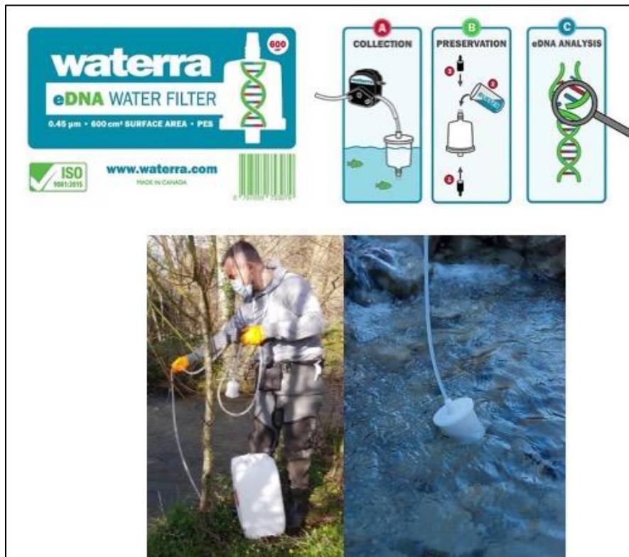
Figure 4 : Filtration in-situ avec capsule Waterra comme préconisé par ARGALY
