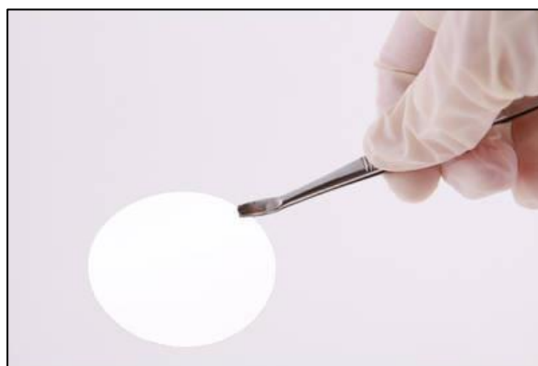
Figure 6 : Membrane filtrante en nitrate cellulose, maille 0,45 µm port de filtration NALGENE.
