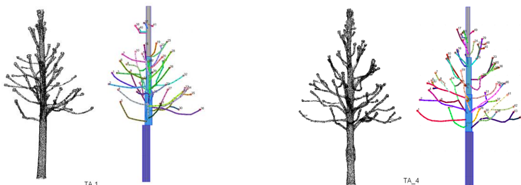
Figure 3.6 : Nuages de points et résultats fournis par ArbreSQUEL sur deux tilleuls argentés
