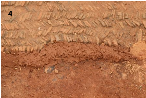
Fig. 35 et 36 : terre, ciment et longs brins de paille, avant et après
