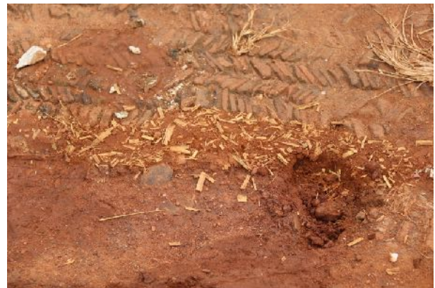
Fig. 35 et 36 : terre, ciment et longs brins de paille, avant et après
