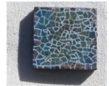
Après 3 cycles de 20 minutes sur REHPTS à 1100 °C
