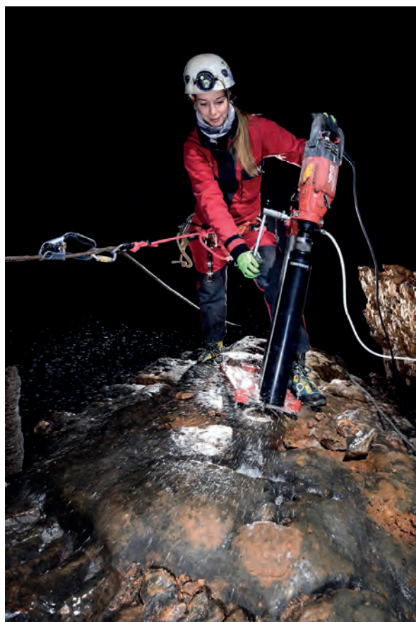
Figure 4 : Carottier 80 mm sur colonne de guidage et refroidissement à eau, ici mis en œuvre sur une grosse stalagmite couchée (Aven d'Orgnac, Ardèche). Photo P. Crochet.
