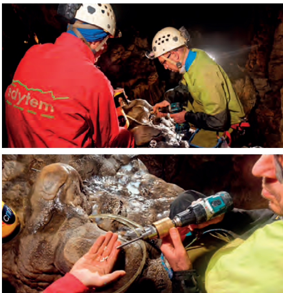
Figure 3 : Carottage de petit diamètre (ici 4 mm intérieur) mis en œuvre avec une visseuse et un pulvérisateur de jardin (Aven d'Orgnac, Ardèche). Photo S. Jaillet.
