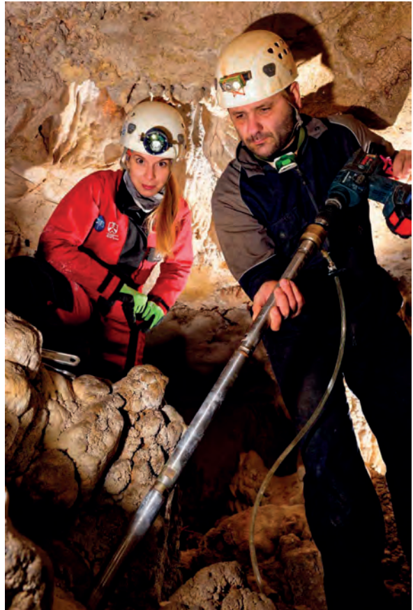
Figure 2 : Mise en œuvre d'un perforateur sur accus avec carottier 32 mm (ici deux rallonges) et refroidissement à eau (grotte Pallas 3, Ardèche). Photo S. Jaillet.
