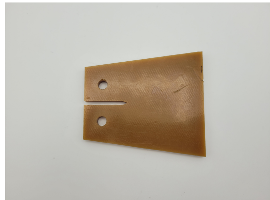
FIGURE 9 – Géométrie TDCB de résine Hexply®M21
