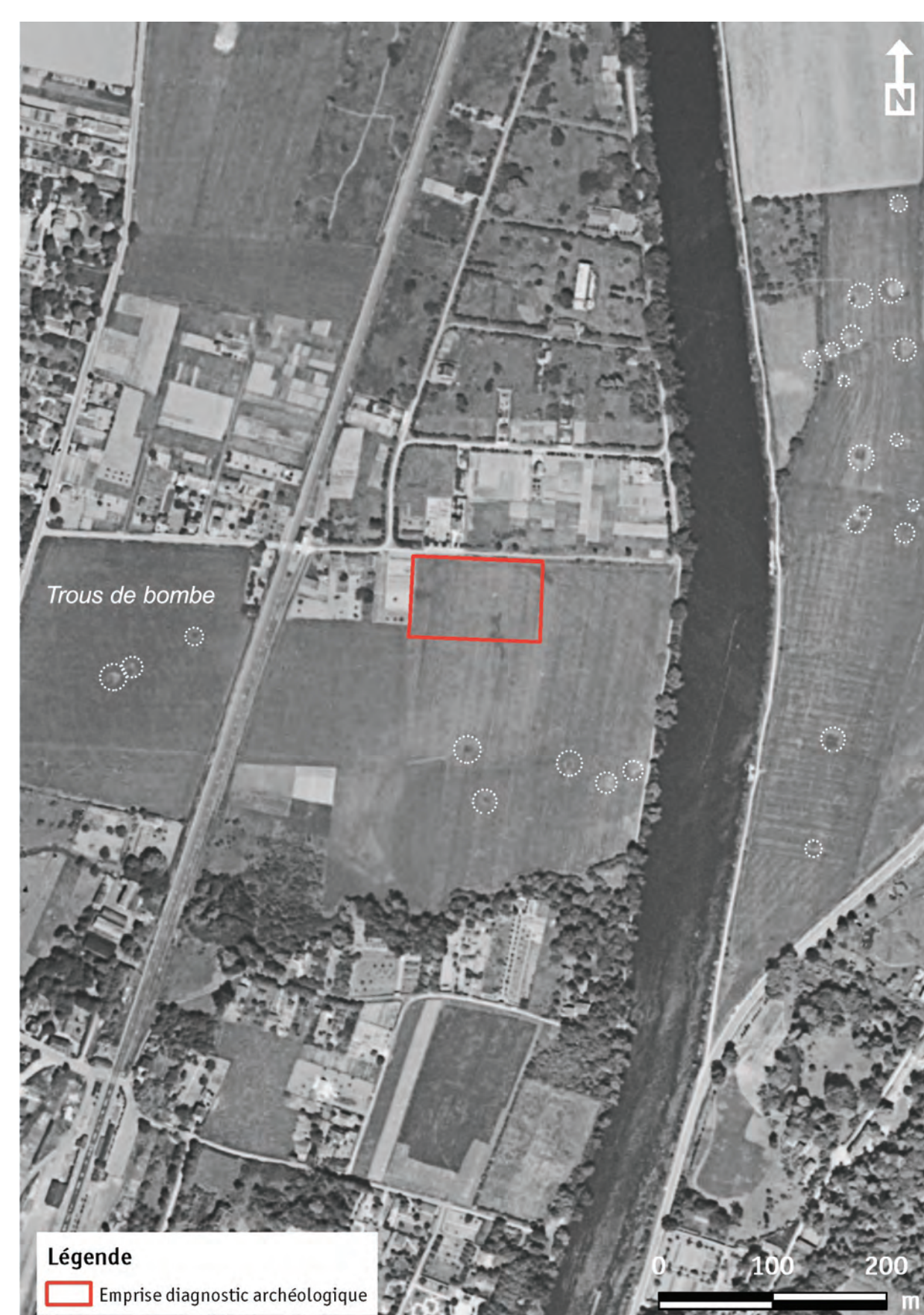
5. À Parmain (Val-d'Oise), les impacts de bombes sont identifiés par des anomalies circulaires de 13 à 15 m de diamètre, grises au centre et par un anneau blanc extérieur. Extrait des photographies aériennes historiques au 1:5.000. Source : IGN ; CD95/DC/SIG SDAVO
