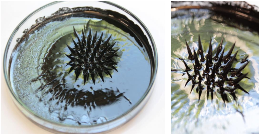
Figure 3 - Instabilités magnétiques de pics lors de l'approche d'un aimant dans le cas du ferrofluide organique surfacté préparé dans la partie B de cet article.
