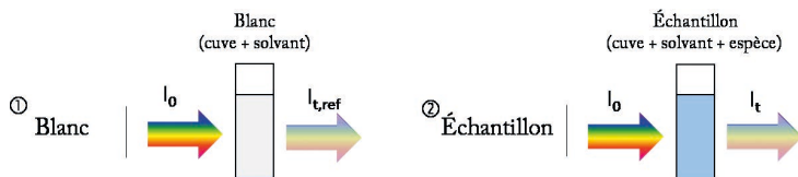
Figure 4 - Principe de mesure de l'absorbance pour un spectrophotomètre monofaisceau.
