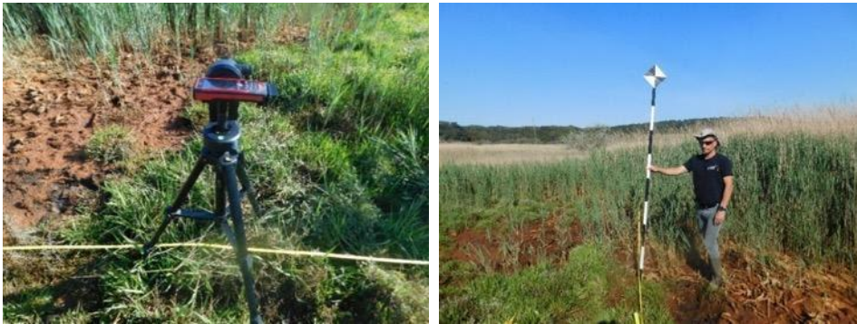
Figure 18 : Distancemètre Leica « Disto S910 » et Cible ayant servi à l'acquisition des points.
