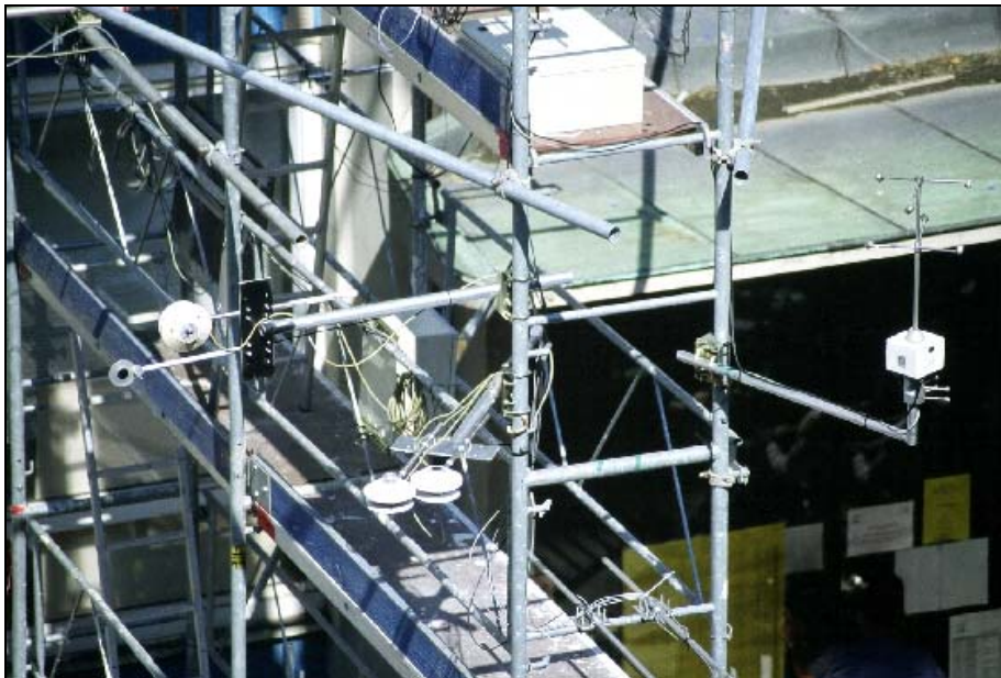
Figure 3 : Photographie de quelques appareils : anémomètre Sonic, bilanmètre, albedomètre... Photography of some measurement devices: Sonic anemometer, bilanmeter, albedometer...
