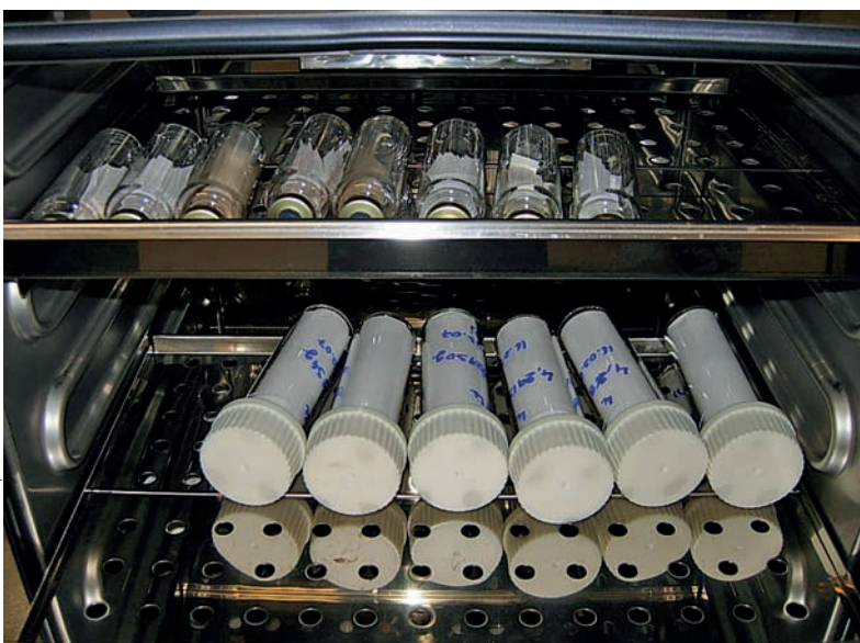
Méthodologie de vieillissement accéléré du papier en tubes hermétiques dans une étuve.
