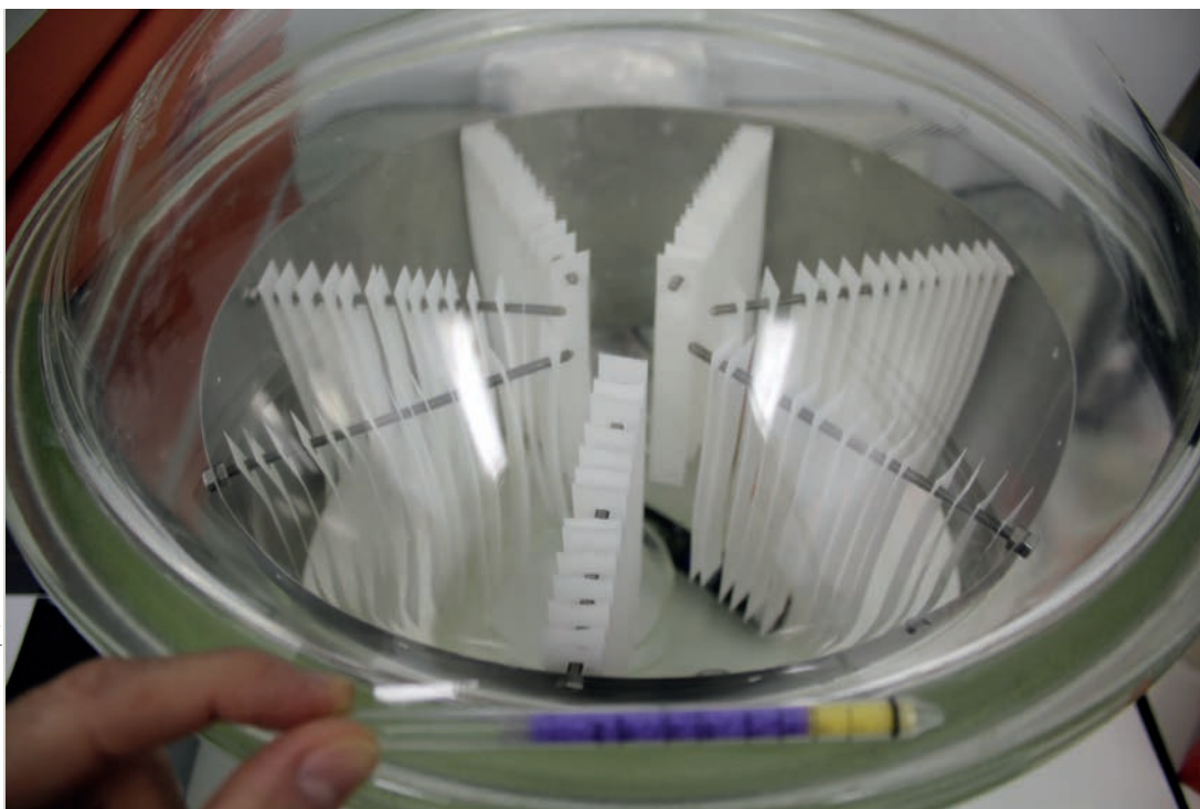
Exposition d'échantillons de papier à des vapeurs acides.
