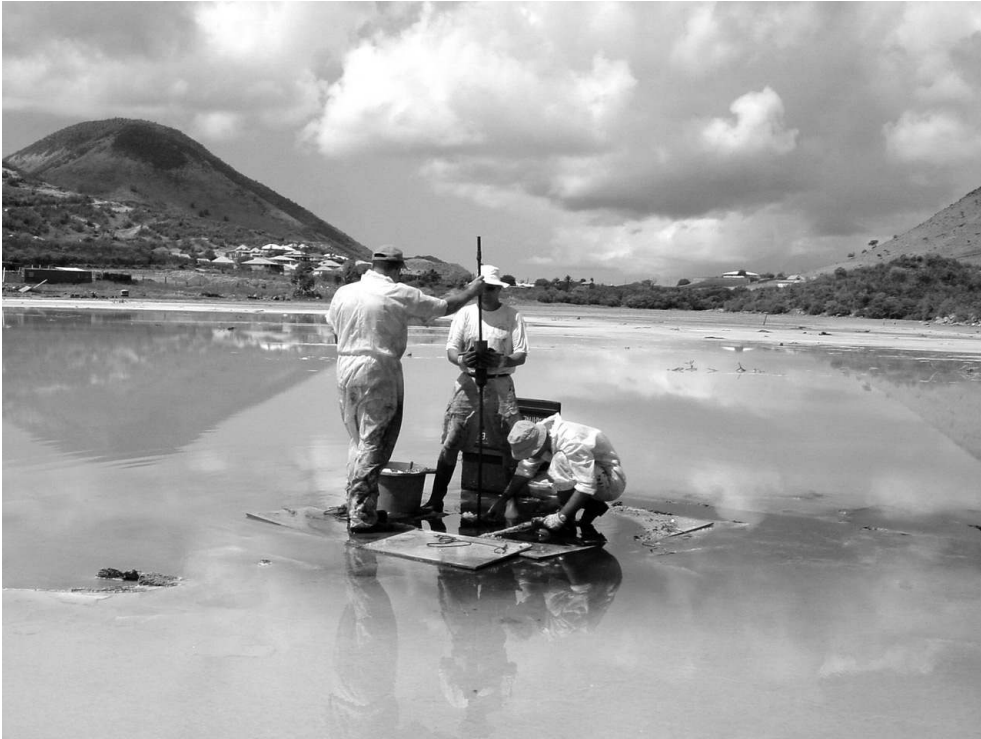
Fig. 6 – Sondage au pénétromètre sur l'étang de Chevrise
