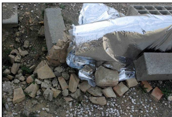
Cloison protégée par un film étanche souple, maintenu par des parpaings (cliché : J.-F. Modat).
