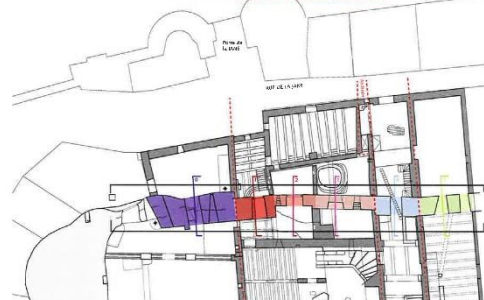
Fig. Épaisseur de l'enceinte depuis la tour nord de la porte des Ormeaux vers l'est. Crédit Chaillot 2013c.
