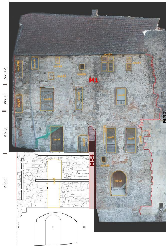
Fig. Parement externe M1. Numérotations des éléments de bâtis, murs et ouvertures. Orthophotographie et levé crédit Pascal Robert-Cols
