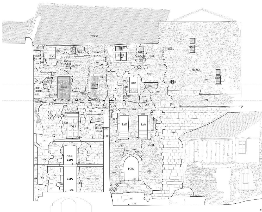
Fig. Façade nord de la maison Fabre sans le bâtiment accolé : matériaux du bâti, levé pierre à pierre et Us de l'étude préalable 2021. Crédit Pascal Robert-Cols
