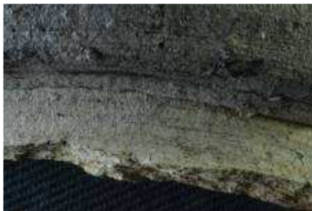
Fig. 310 : Macrophotographie d'une céramique de l'antiquité tardive qui porte des fentes de retrait différentielles (3421,01).
