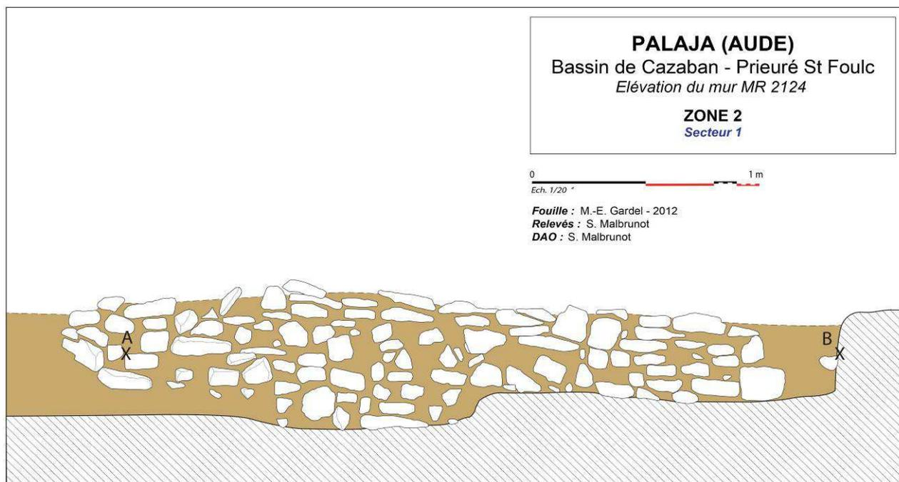
Fig. 118 : Elévation du mur MR 02.124
