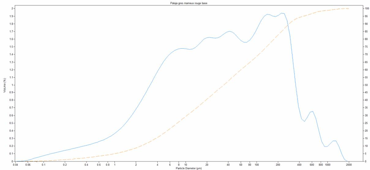
Fig. 463 : courbes granulométriques différentielle et cumulative du grès marneux rouge de la base de la base de la fouille.
