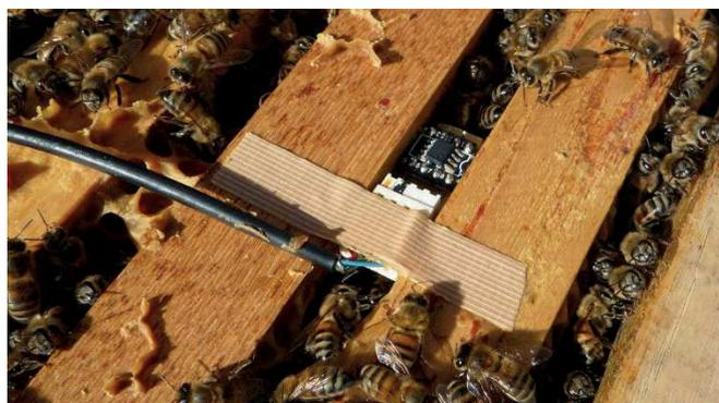
**Photo 12. Détail d'un capteur de température qui enregistre les variations au cours du temps dans une ruche**
