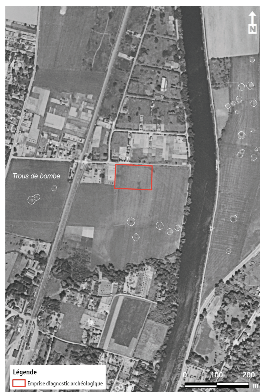
Figure 05. À Parmain (Val-d'Oise), les impacts de bombes sont identifiés par des anomalies circulaires de 13 à 15 m de diamètre, grises au centre et par un anneau blanc extérieur. Extrait des photographies aériennes historiques au 1:5.000 (source : IGN ; CD95/DC/SIG SDAVO).
