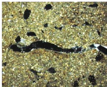
d. torchis limoneux, préparation moins élaborée. S1, XPL, l. i. 4 mm.
