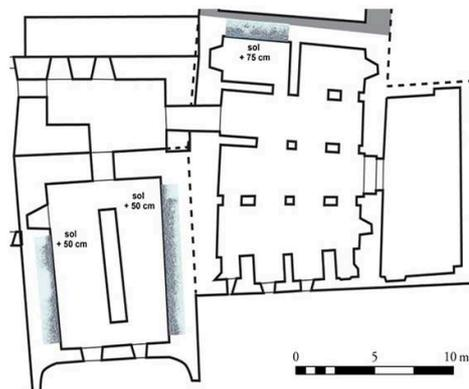
Fig. 12. Recherche avec le Radar du rebouchage d'un ancien accès dans la Tour Saint-Andoche à Autun (Saône-et-Loire).
