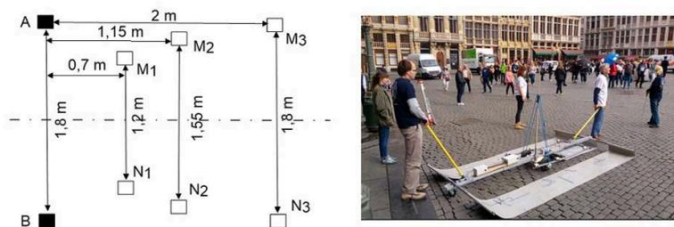
Fig. 2. Dispositif de prospection électrostatique utilisé en milieu urbain. Les pôles sont des tissus en fil de cuivre placés sur les tapis de PVC et disposés selon le schéma. Les mesures portent simultanément sur trois profondeurs d'investigation. Appareil utilisé pour la prospection de la 'Grand-Place' de Bruxelles.
