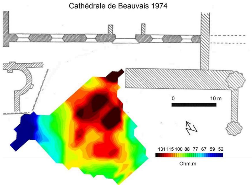
Fig. 7. Cartographie de la résistivité électrique (Quadripôle Wenner  $a=1,5$  m) au sud de la cathédrale Saint-Pierre de Beauvais.
