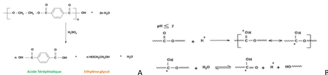
Figure 9 : Solvolyse du PET en milieu aqueux acide (H 2 SO 4 ), avec la coupure des chaînes polymères (A) et, à droite, une proposition de mécanisme de la réaction d'hydrolyse (B) (d'après Sinha et al., 2010).
