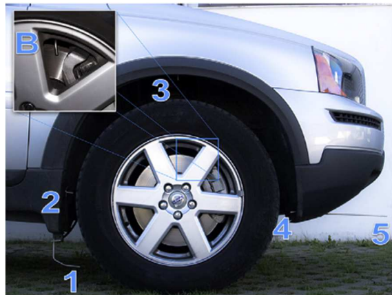
Figure 14 : Position des tubes d'échantillonnage (Mathissen et al. 2011).
