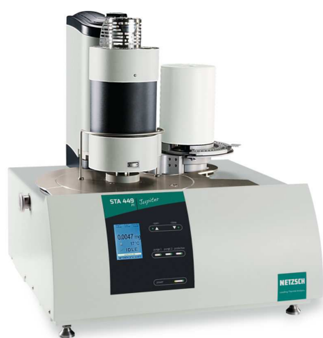
Figure 97 : ATG DSC Jupiter STA449F1 de Netzsch.
