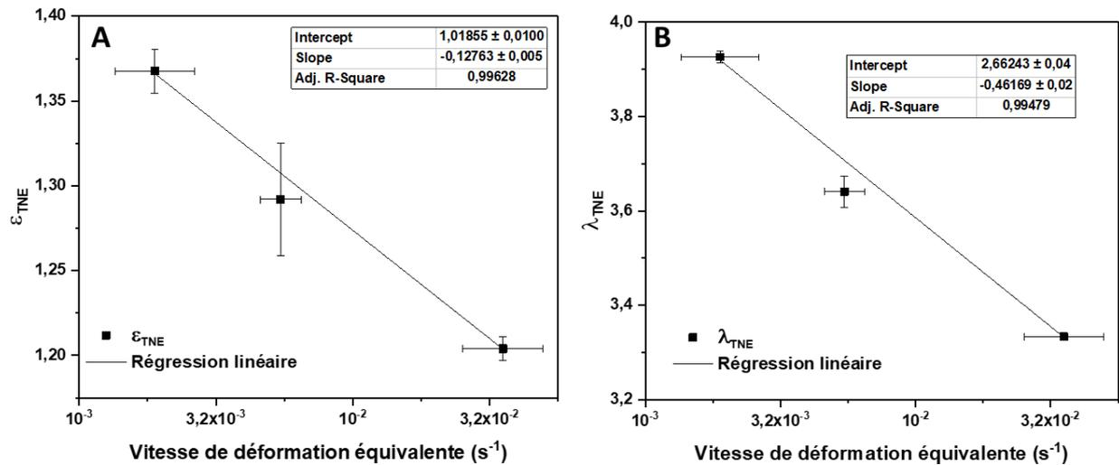
Figure 11. Déformation vraie de Hencky  $\epsilon_{TNE}$  (A) et taux d'étirage  $\lambda_{TNE}$  (B) au durcissement structural en fonction de la vitesse de déformation équivalente et régression linéaire.
