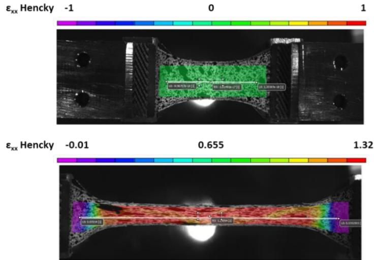
Figure 2. Champs de déformation vraie  $\epsilon_{xx}$  obtenus lors d'un essai d'étirage uni-axial à 95°C et 0.25 s<sup>-1</sup> à l'instant initial et en cours de déformation
