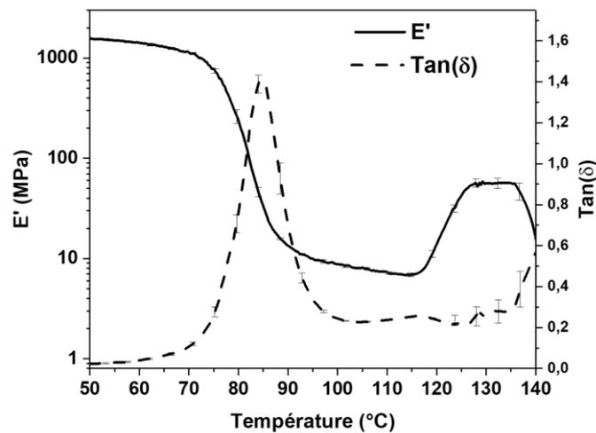
Figure 7. Module de stockage  $E'$  (trait plein) et tangente de l'angle de perte  $\tan(\delta)$  (trait pointillé) du RPET mesurés par analyse DMA en mode traction sinusoïdale à une fréquence de 1 Hz dans le domaine visco-élastique (moyenne sur six essais).
