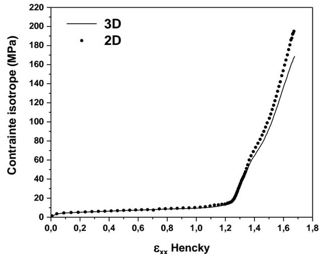
Figure 3. Comparaison des courbes contrainte vraie - déformation vraie obtenues avec VIC3D (trait plein) et VIC2D (points)
