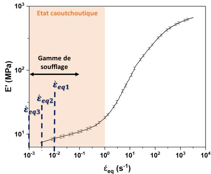
Figure 8. Courbe maîtresse du module de stockage  $E'$  en mode traction à une température de référence de 85 °C et une déformation d'environ 0.04 %. Moyenne sur cinq scans en fréquence de 0.2 à 15 Hz, entre 75 et 105 °C avec un pas de 5 °C. Les vitesses de déformation équivalentes visées lors des essais d'étirage sont indiquées en bleu.
