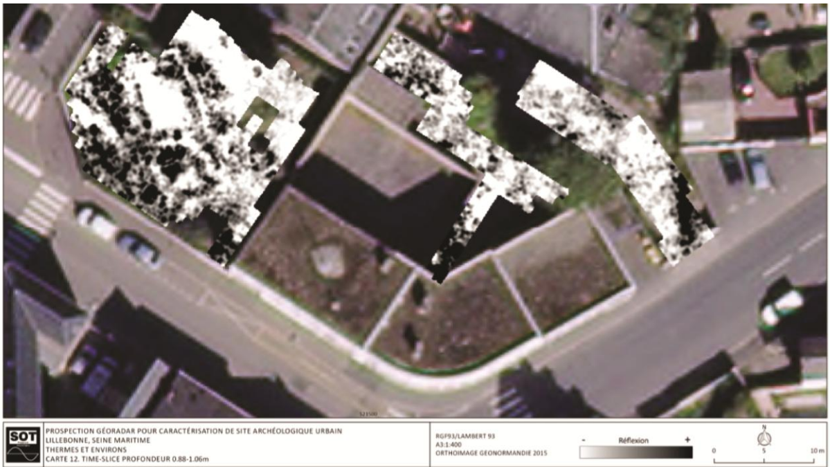
Anomalies géoradar entre 0,70 et 0,89 mètre © Sala - SOT Archaeology
