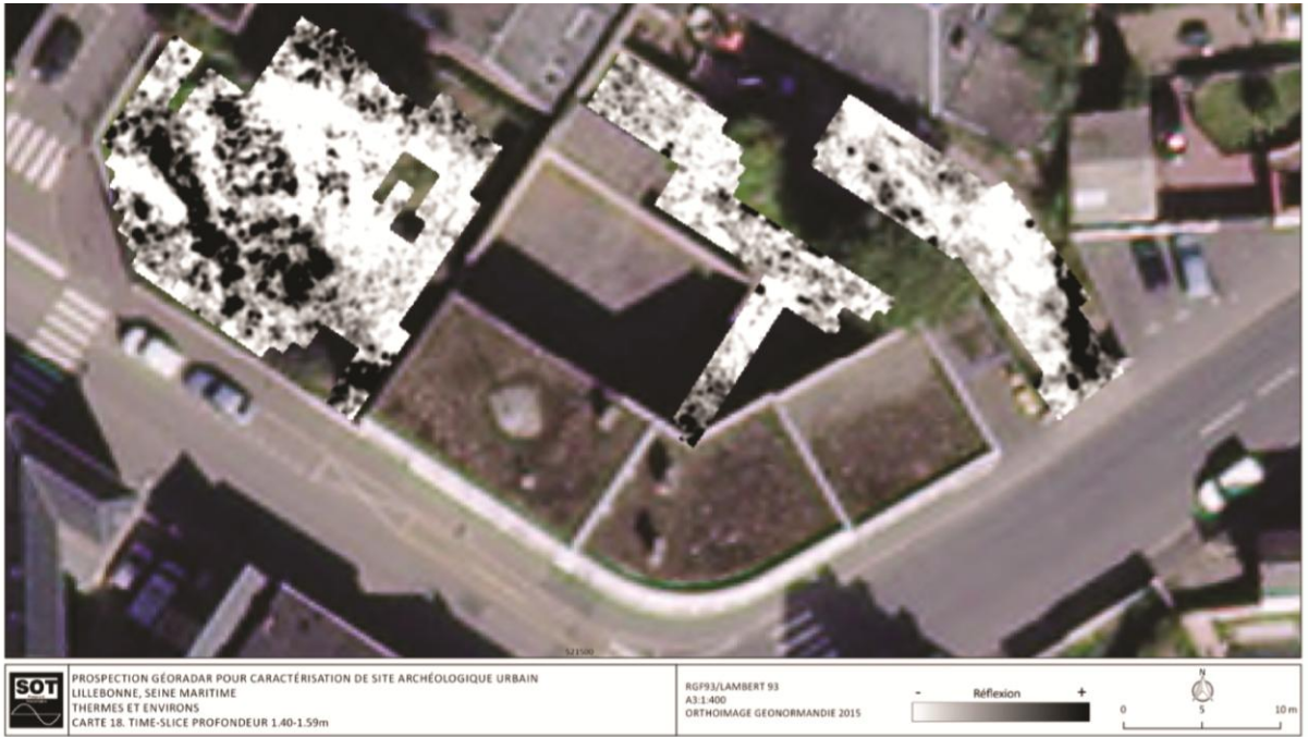
Anomalies géoradar entre 1,40 et 1,59 mètre © Sala - SOT Archaeology
