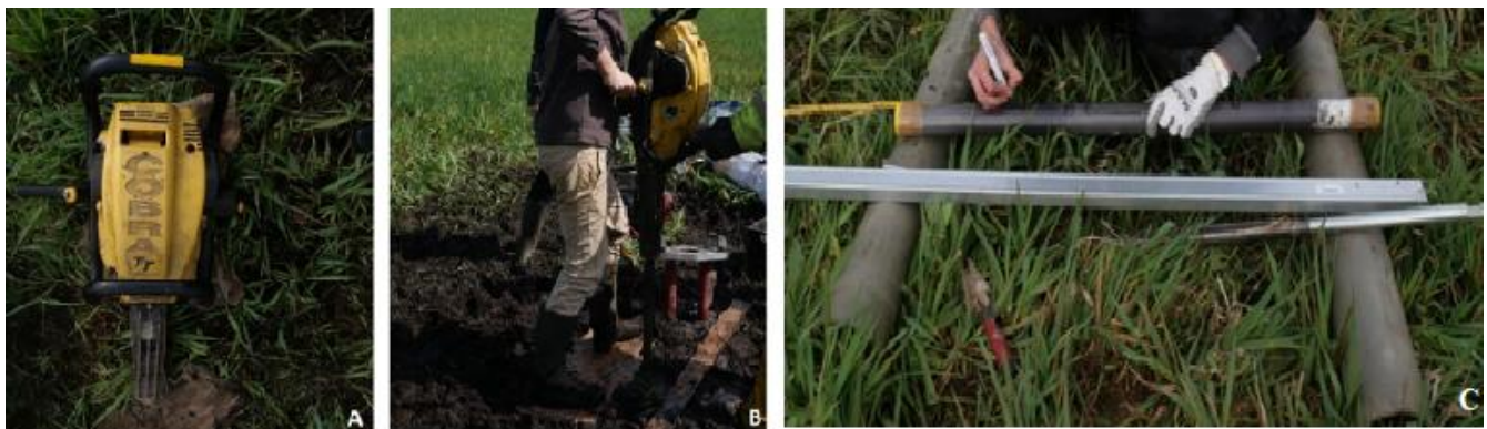
Fig. 18 : Carottier à percussion en phase de sondage (A et B) et annotation des carottes (C) © Université de Rouen
