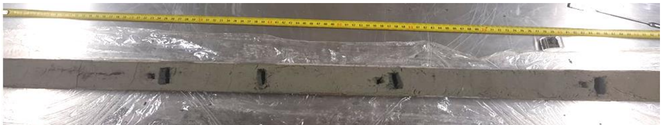
Fig. 24 : Échantillonnage d'une demi-carotte. Prélèvements de 5 g et de 2 g. © Université de Rouen
