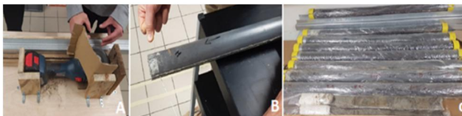
Fig. 19 : (A) Ouverture des carottes à la meuleuse, (B) séparation des sédiments au fil de pêche, (C) demi-carottes plastifiées © Université de Rouen
