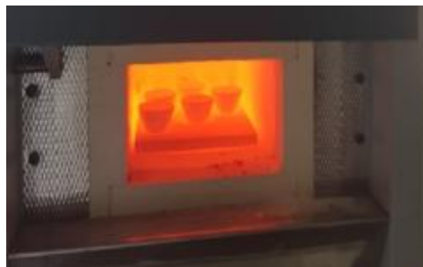
Fig. 22 : Calcination des échantillons à 1100 °C © Université de Rouen
