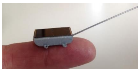
Figure 13 : Les émetteurs spécialement conçus pour ICARUS ne pèsent que cinq grammes
