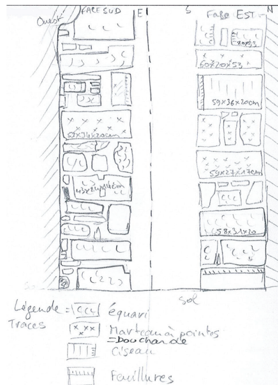
Pilier 1014. Détail de la taille des pierres du moyen appareil.
