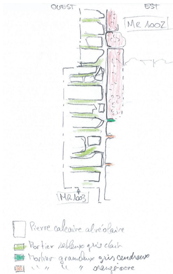
1003. Détail de l'appui du pilier 1003 sur le mur MR1002 au rez-de-chaussée.
