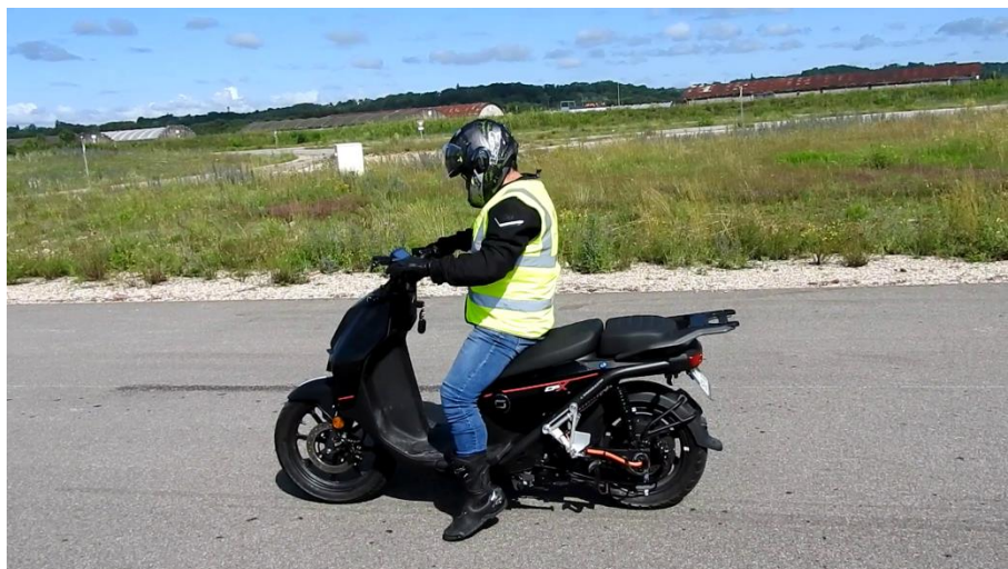
Figure 3 : Moto légère électrique, genre MTL ( \Leftrightarrow 125cm 3 ), type "Scooter", Super Soco CPx
