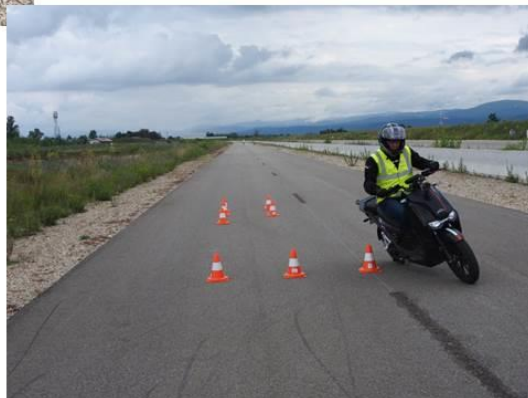
Figure 5 : Expérimentation sur piste (freinage, évitement), moto et scooter légers électriques (MTL)
