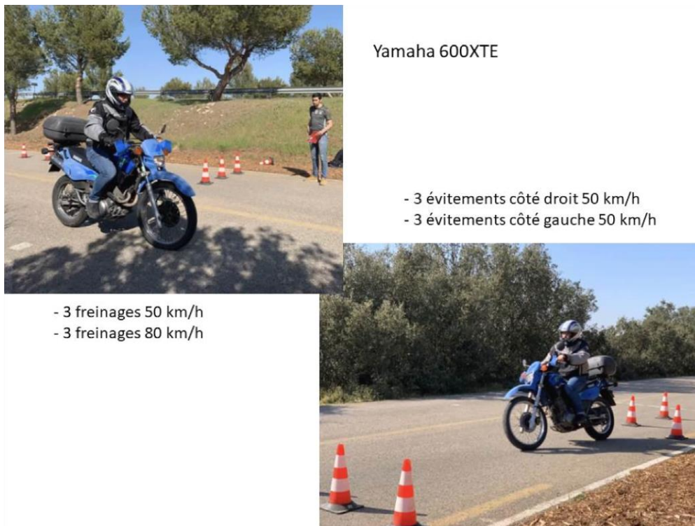
Figure 4 : Expérimentation sur piste (freinage, évitement), Yamaha 600 XTE
