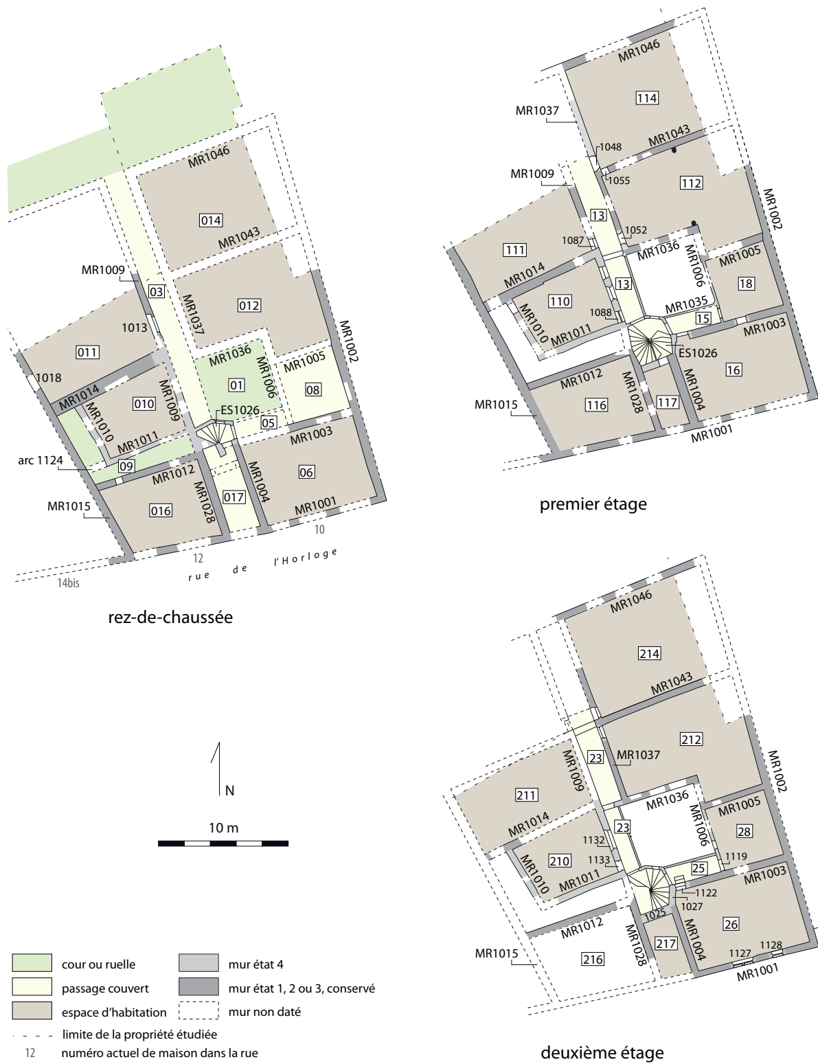
Fig. 20 La maison du 10 rue de l'Horloge dans son troisième état (état 4), vers 1530.
