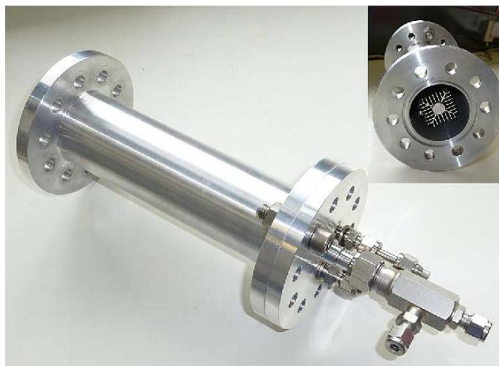
Figure 3. Al-Alloy hydrogen storage tank developed by Institut für Energie- und Umwelttechnik/Max-Planck-Institut für Kohlenforschung (IUTA/MPI). Reprinted with permission from reference [38]. Copyright 2014 Elsevier.
