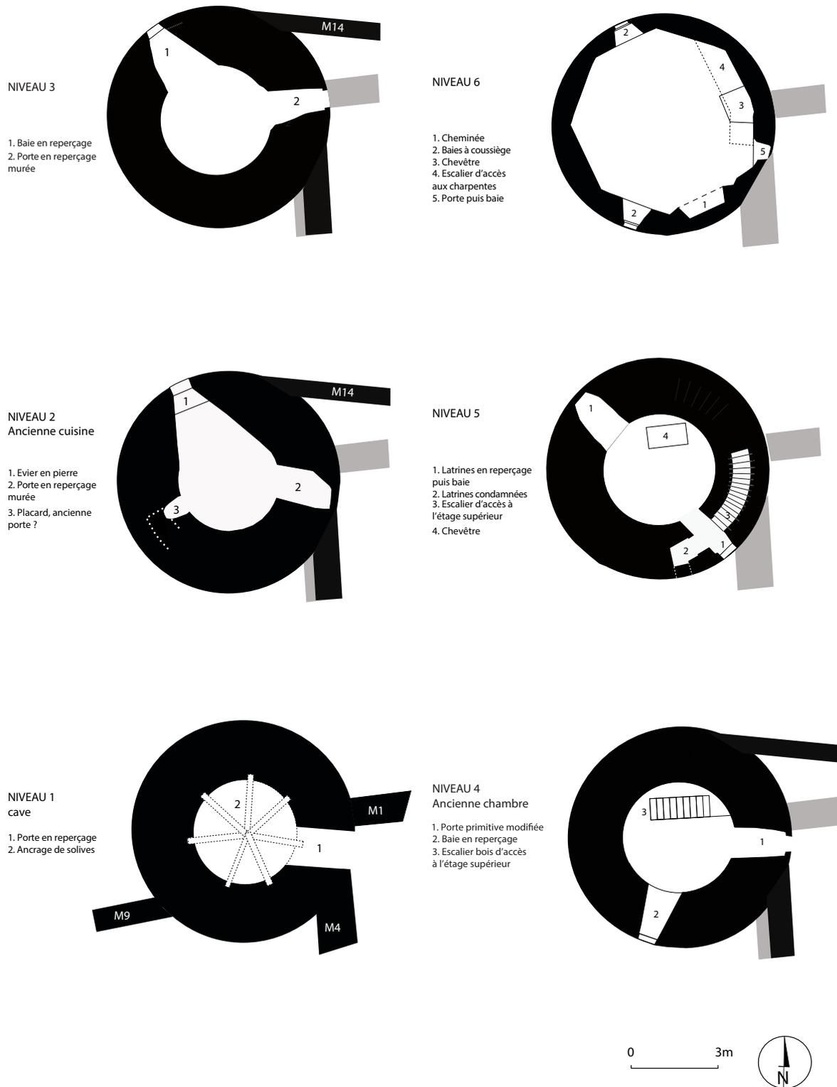
Figure 8 : Plan par niveaux de la tour de la Barrière. (Relevés C.M)
