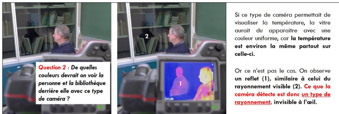
Figure n°3 – Mise en évidence du reflet infrarouge dans une vitre
