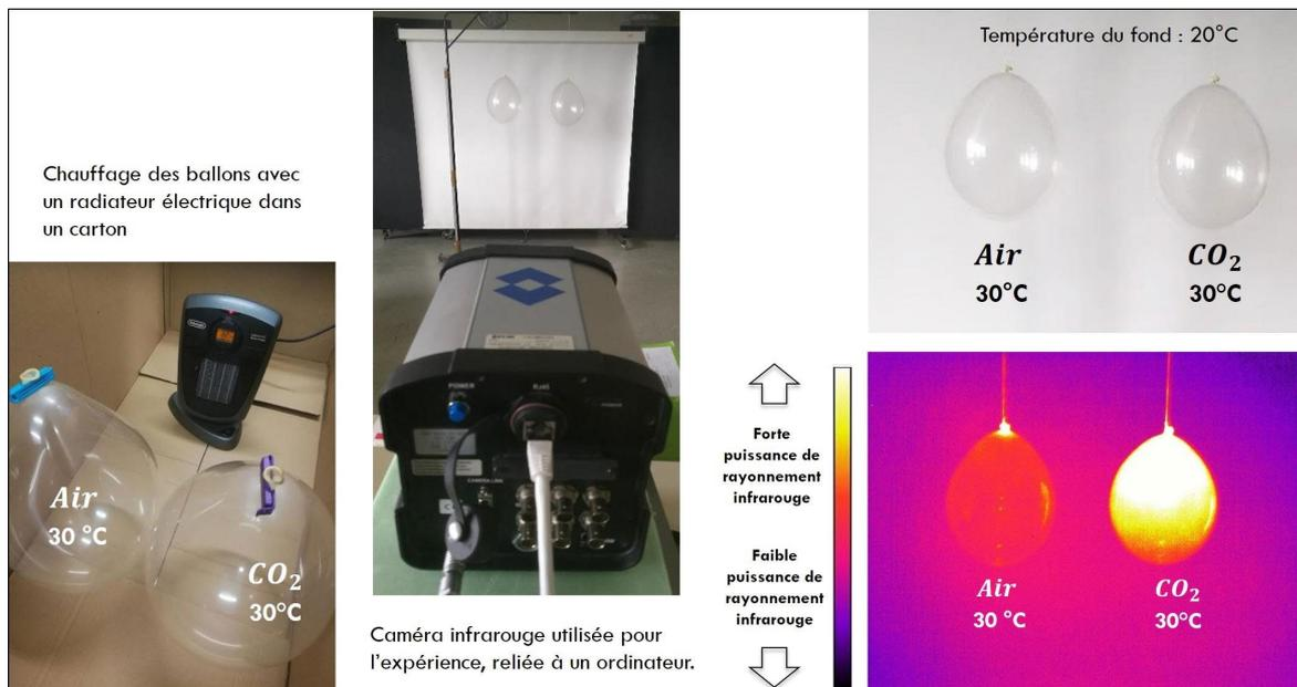
Figure n°9 : Ballons d'air et de CO<sub>2</sub> chauds observés avec une caméra infrarouge
