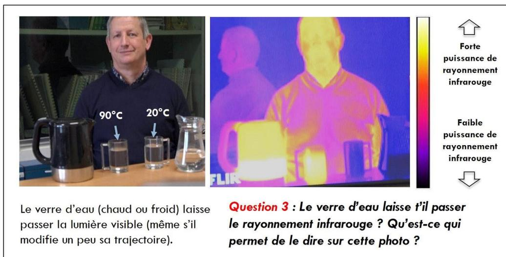
Figure n°5 : Rayonnement visible et infrarouge à travers la matière
