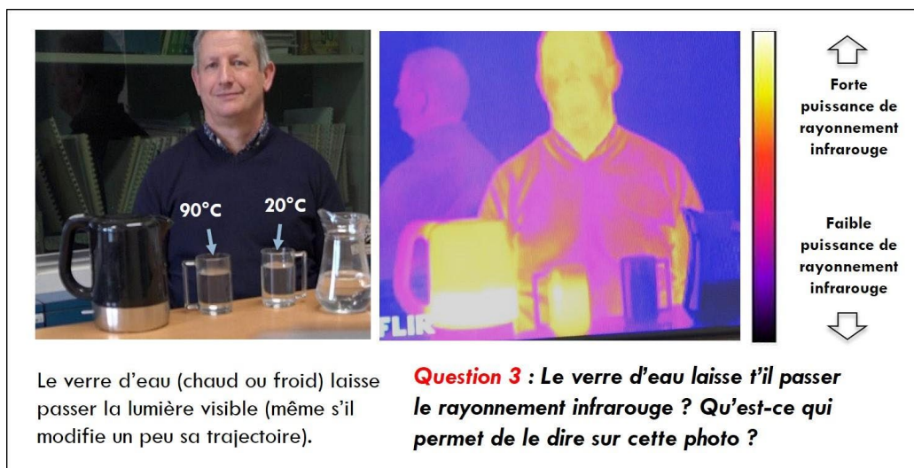
Figure n°5 : Rayonnement visible et infrarouge à travers la matière
