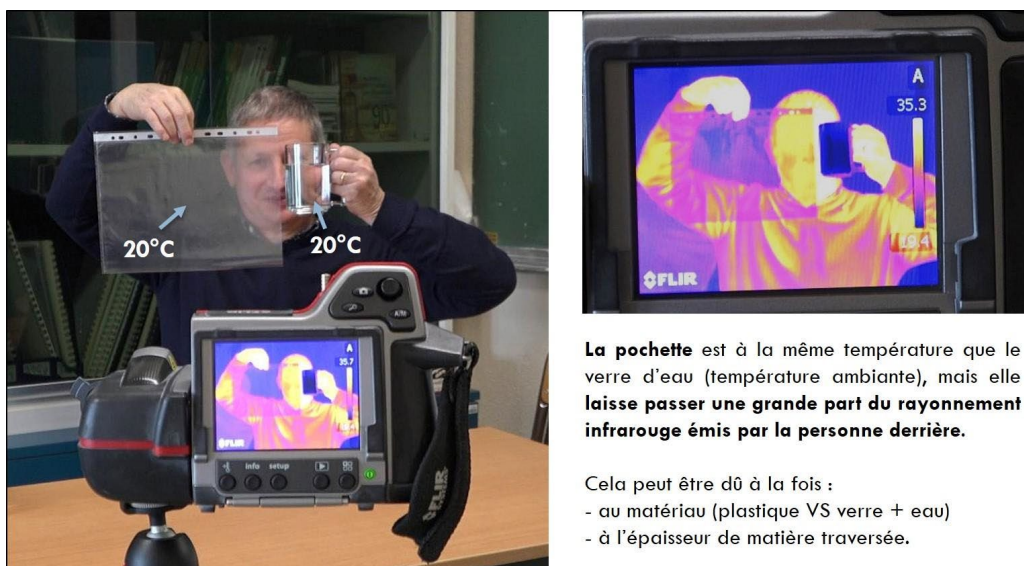
Figure n°6 : Rayonnement infrarouge à travers une pochette plastique et un verre d'eau
