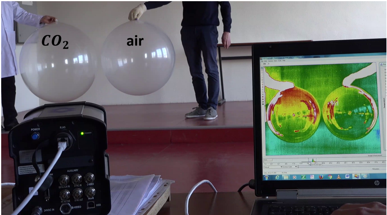
Figure 3 : ballons en latex préalablement placés dans une pièce chauffée à 25^{\circ}C , avant d'être déplacés dans une pièce plus froide ( 10^{\circ}C ), et observés avec caméra infrarouge. A gauche : ballon rempli de CO_2 pur. A droite, ballon rempli d'air. On constate que pour une même température, le CO_2 émet davantage de rayonnement infrarouge.
