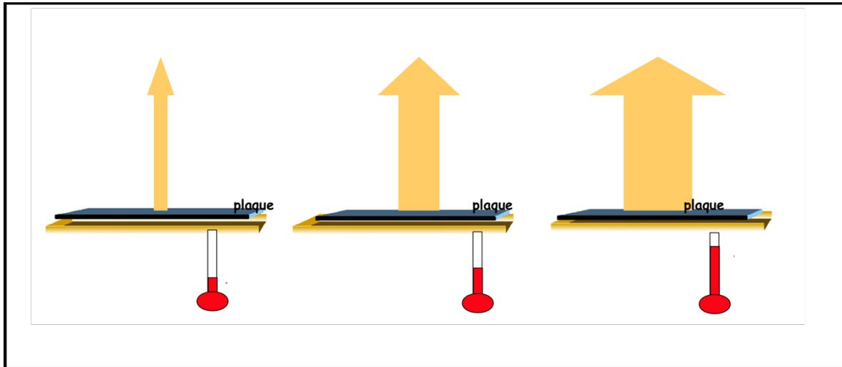
Figure 5 : plaques de métal à différentes températures. La flèche représentant le rayonnement infrarouge à un instant donné est d'autant plus large que la puissance de rayonnement est grande.
