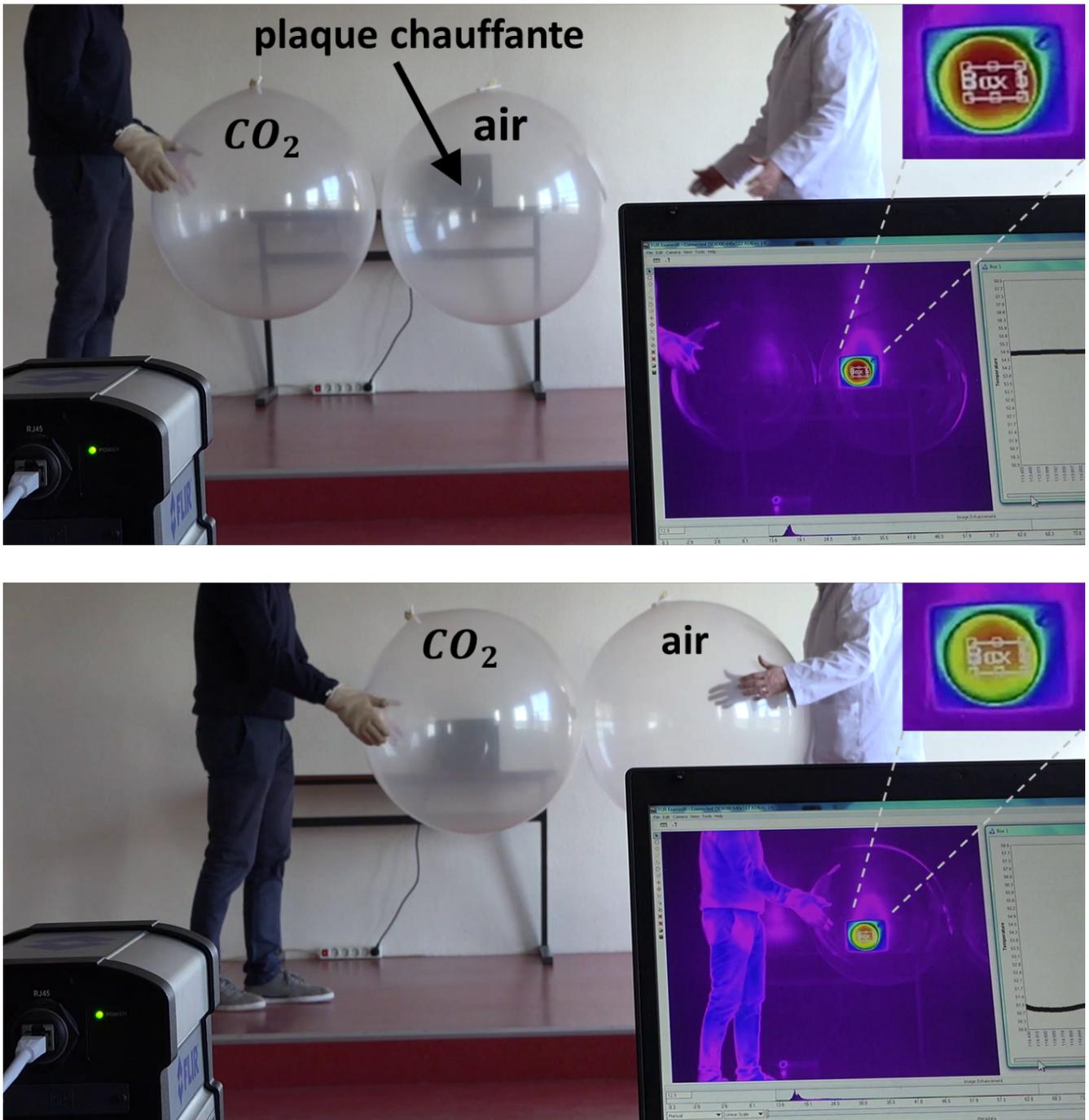
Figure 4 : ballons en latex, remplis de  $CO_2$  pur et d'air, placés successivement devant une plaque chauffante et observés avec une caméra infrarouge. On constate que lorsque le ballon de  $CO_2$  est devant la plaque, la puissance de rayonnement infrarouge mesurée par la caméra diminue. Le rayonnement visible traverse cependant de la même façon le ballon de  $CO_2$  et le ballon d'air.
