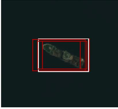
Fig. 4. Illustration de la détection d'un même objet par plusieurs cellules voisines. Après application de l'algorithme NMS, seule la boîte en blanc est conservée. Imagery Products © 2018 Maxar Technologies.
