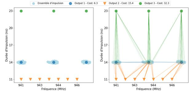
Fig. 11. Résultats de la classification pour l'ensemble d'impulsion 3.
