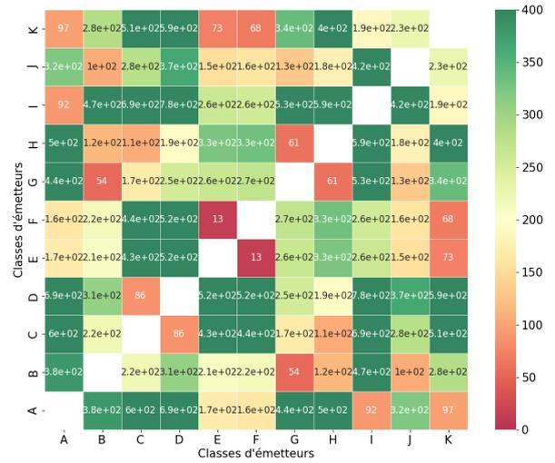
Fig. 8. Matrice de coûts entre les classes d'émetteurs simulés construite à partir de la fréquence et de la durée d'impulsion. Une couleur verte indique un coût de transport faible tandis que le rouge représente un coût élevé.
