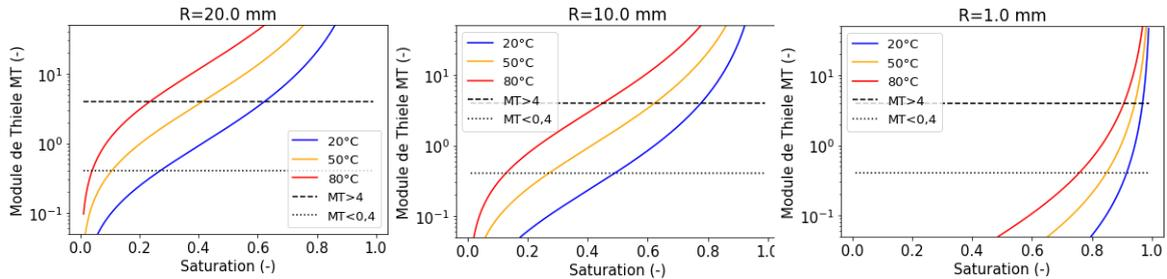
**FIGURE 3.** Domaine de validité du modèle « shrinking-core » contrôlé par la diffusion au-dessus de la droite en pointillés gras ( $M_T > 4$ ) et contrôlé par la réaction en dessous de la droite en pointillés fins ( $M_T < 0,4$ ) sur des grains de rayon 20 mm, 10 mm et 1 mm.
