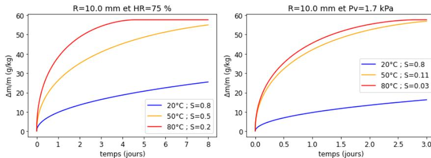
**FIGURE 6.** Piégeage de CO<sub>2</sub>  $\Delta m/m$  en g de CO<sub>2</sub> par kg de béton à HR constante à gauche et à P<sub>v</sub> constante à droite.
