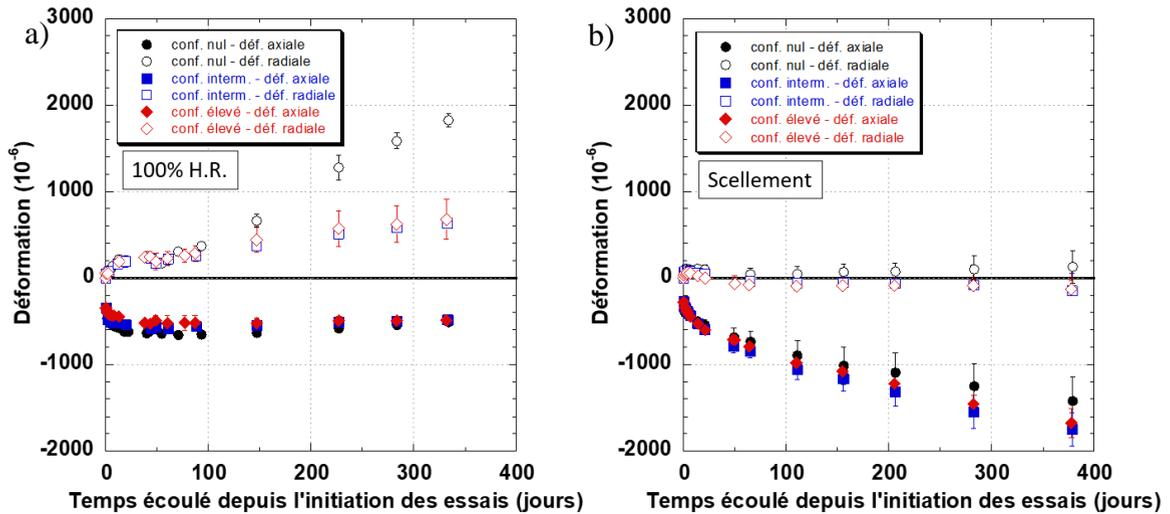
**FIGURE 5** Évolution des déformations dans les éprouvettes chargées axialement en fonction du niveau de confinement latéral (nul, intermédiaire, élevé): a) à 100% H.R.;
