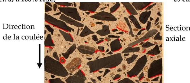
**FIGURE 6** Photographie d'une plaque polie du mélange de béton de masse de la présente étude illustrant la localisation (traits en rouge) de vides et de zones très poreuses aux interfaces pâte-granulat (tiré de Darveau, 2021).
