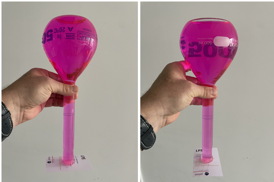
FIGURE 10 – Fiole jaugée renversée sur une carte de visite. À gauche : en l'absence de bulle. À droite : en présence d'une bulle. Crédits (Frédéric Restagno).
