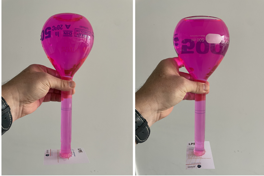
FIGURE 9 – Fiole jaugée renversée sur une carte de visite. À gauche : en l’absence de bulle. À droite : en présence d’une bulle. Crédits (Frédéric Restagno).
