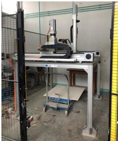
Figure 3. Imprimante cartésienne utilisée pour les essais d'impression à échelle 1
