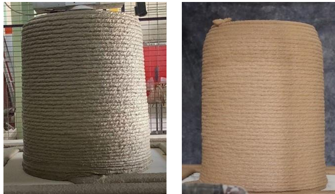
Figure 7. Mortiers de référence (sur la gauche) et ternaire (sur la droite) imprimés à échelle 1
