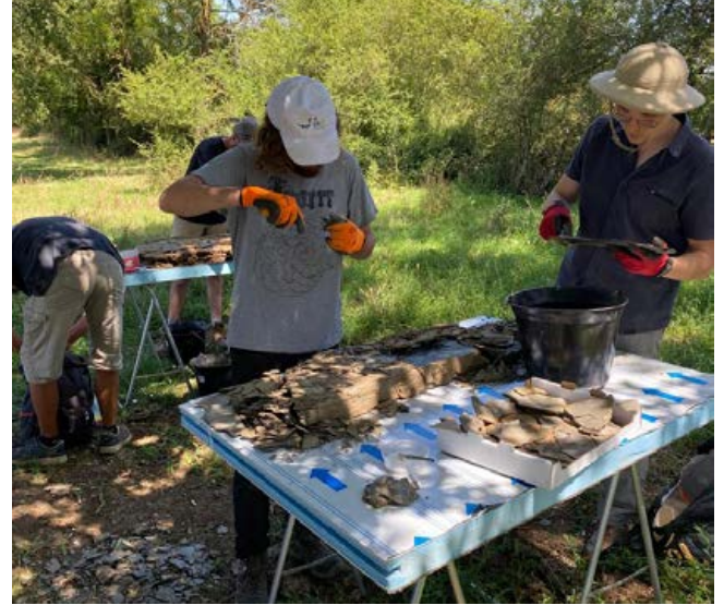
Figure 2 : Extraction et clivage des "schistes" de Franchesse (© Guillaume Houée & Auriane Kida).
