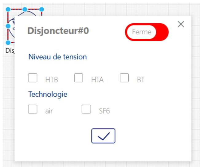
Fig 4 : Paramétrage d'un disjoncteur
