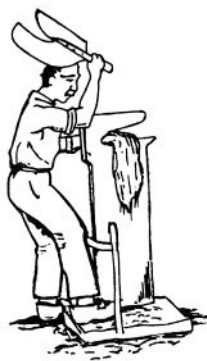
Fig. 12 – Teilleur de lin utilisant un écang et une planche à teiller (© musée du Lin de Courtrai, Belgique).
